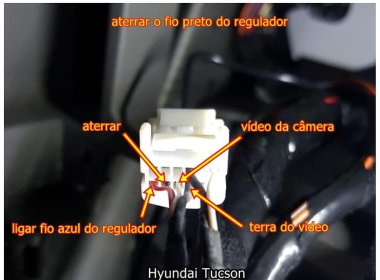
As cores podem variar de veículo para veículo, siga a posição dos fios no conector,
