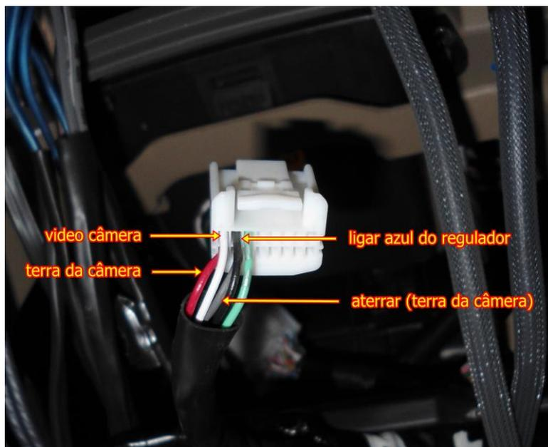
As cores podem variar de veículo para veículo, siga a posição dos fios no conector.
