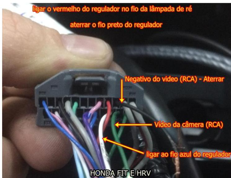
As cores podem variar de veículo para veículo, siga a posição dos fios no conector.
