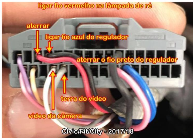
As cores podem variar de veículo para veículo, siga a posição dos fios no conector.
