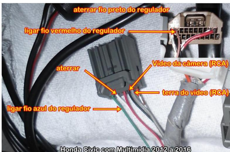
As cores podem variar de veículo para veículo, siga a posição dos fios no conector.
