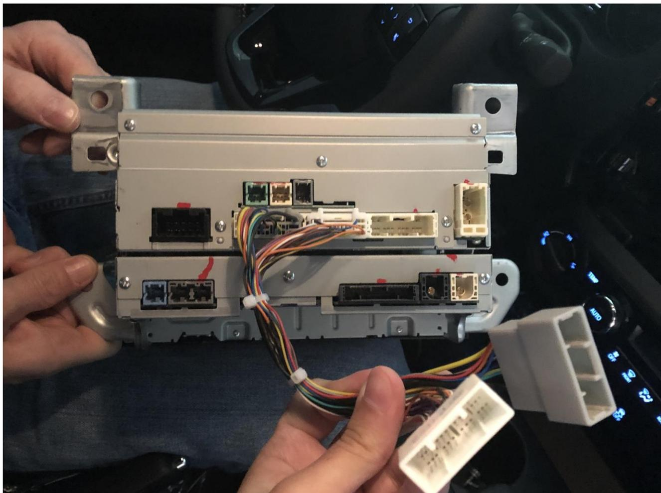
Faça toda a instalação com a ignição do veículo desligada
